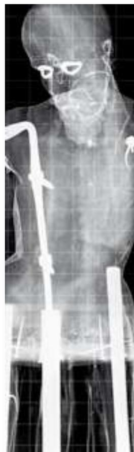
Radiografía donde se pueden apreciar los elementos metálicos presentes en la imagen: estructura de devanadera metálica y mecanismo de movimiento del brazo derecho.
